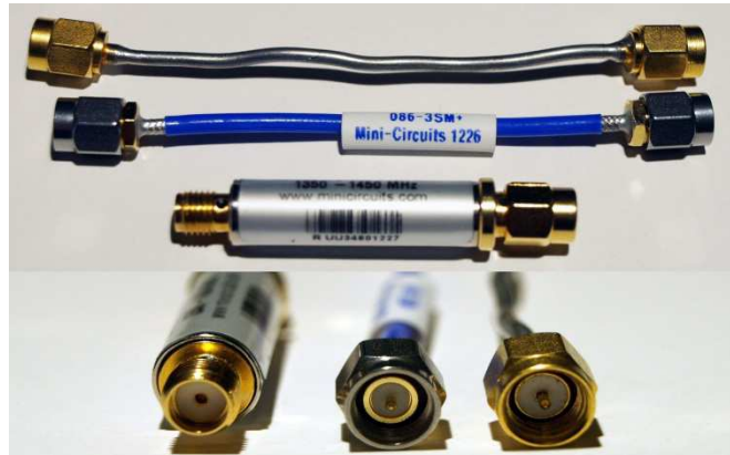
Abb. 1: Semi-Rigid-Leitungen und Bandpassfilter mit SMA-Stecker und Buchse
