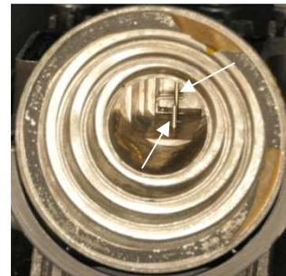
Abb. 11: Die Empfangsöffnung des LNBs mit den beiden Empfangsdipolen
