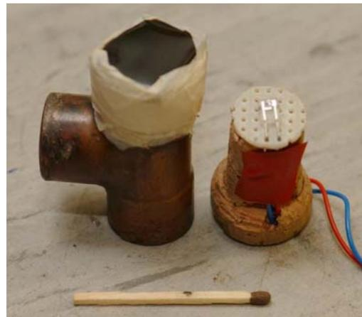
Abb. 5: Weitwinkelsensor (links) und Nachführsensor (rechts) mit IR-Filter
