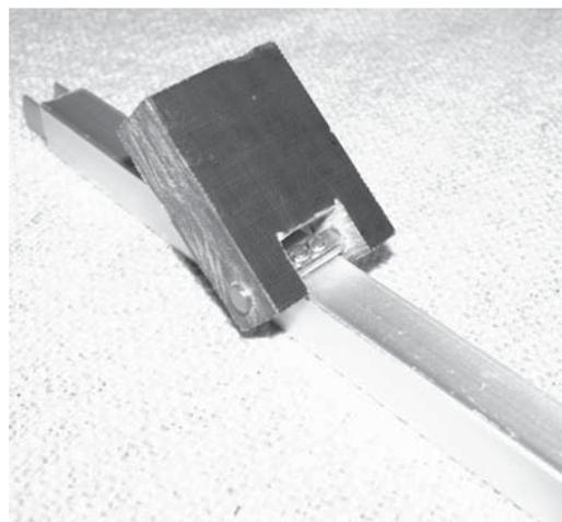
*Abb. 2: Befestigung des Greifarms an der Gabelachse*
